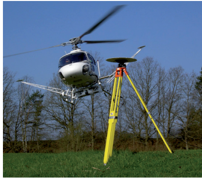
Helikopter en laseraltimetriesysteem in rek; twee GPS-ontvangers op masten aan weerszijden zorgen voor een betere positie- en standbepaling, het GPS-basisstation op de grond zorgt voor een differentiële positiebepaling.
